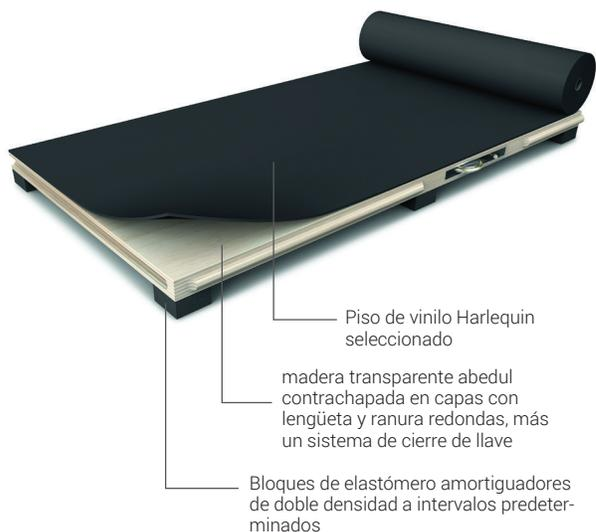
**Harlequin Liberty LatchLoc** es un sistema modular de tarimas flexibles fabricados de madera aglomerada y bloques de elastómero de doble densidad ubicados en la parte inferior del panel para dar una amortiguación uniforme. ILs paneles se colocan en forma de ladrillo en el sub-suelo, de manera que las uniones no coincidan. Se unen entre sí por una lengüeta de madera, que se fija en su sitio mediante un mecanismo de cierre de llave.
