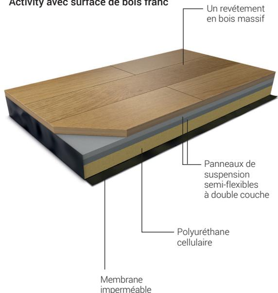
**Harlequin Activity** est un système de planchers flottants installé en permanence, basé sur la construction largement utilisée du « triple sandwich » pensé par Harlequin, il y a plus de 30 ans. C'est un système entièrement flottant sans fixation au sous-plancher qui peut être posé sur une surface raisonnablement lisse et plane, sans préparation préalable.
