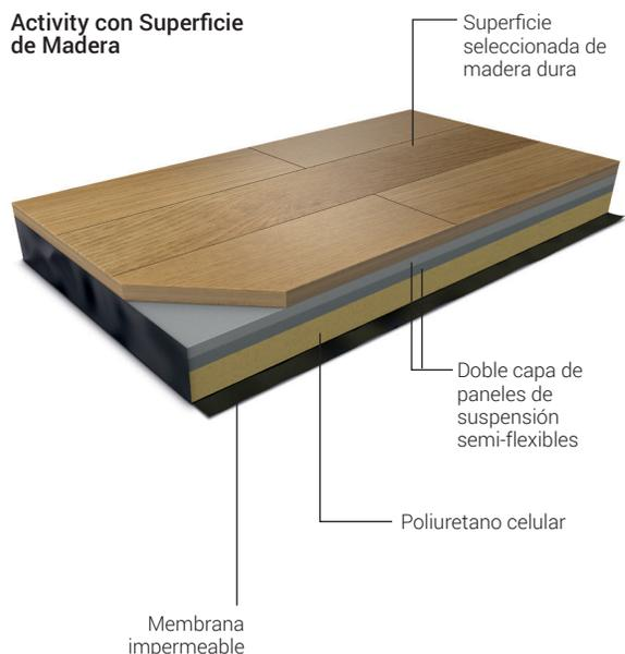
**Harlequin Activity** es un sistema de piso flexible instalado de forma permanente para usos múltiples, basado en el reconocido tipo de construcción de "triple-sándwich" creado por Harlequin hace más de 30 años. Es un sistema totalmente flotante sin fijaciones al sub-suelo y se puede colocar en cualquier superficie razonablemente plana y sin preparación previa.
